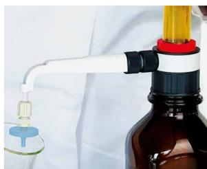
Filtration stérile de fluides directement à partir du flacon avec la canule de distribution à raccord Luer-Lock
