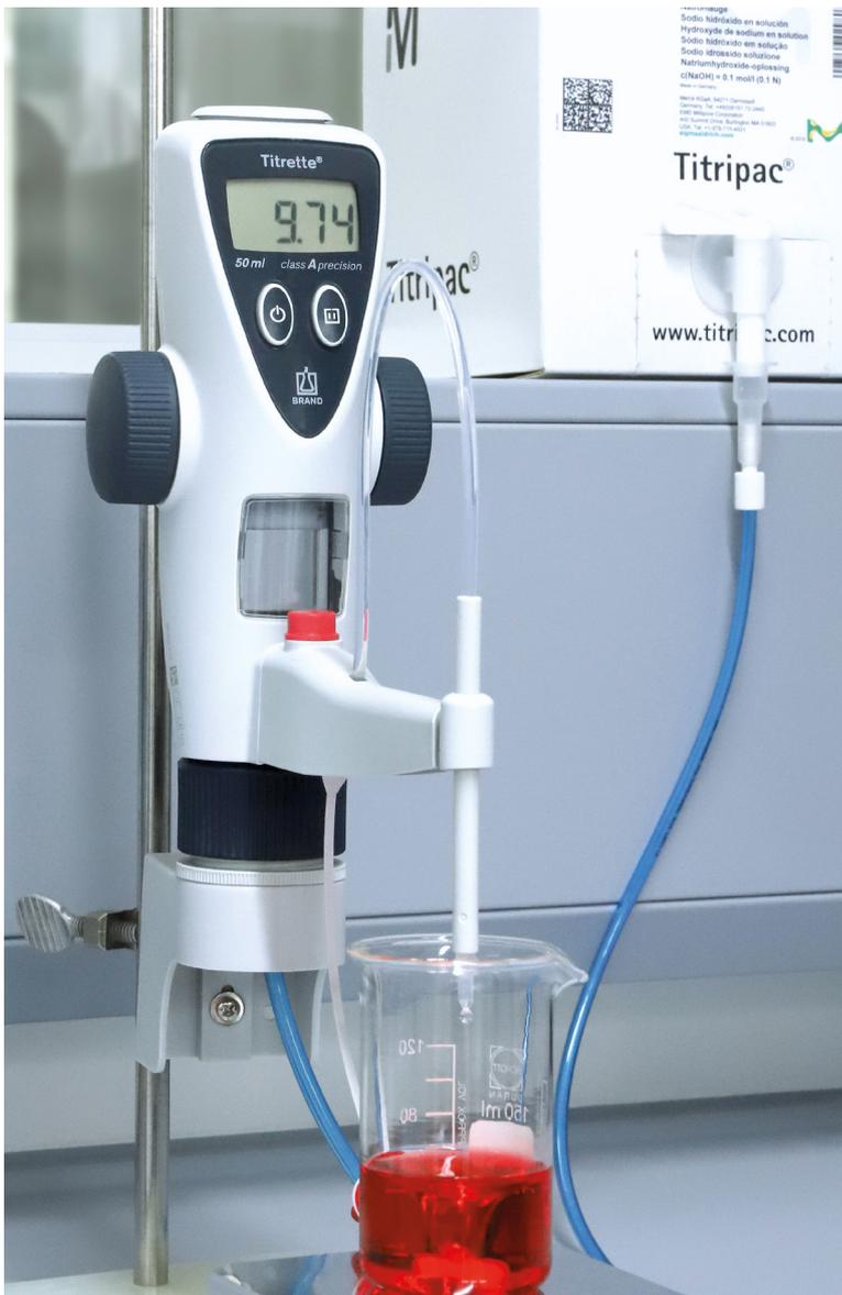
Système de prélèvement Titrette® pour système d'emballage Bag-in-Box
