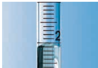
刻度移液管中的凸液面
