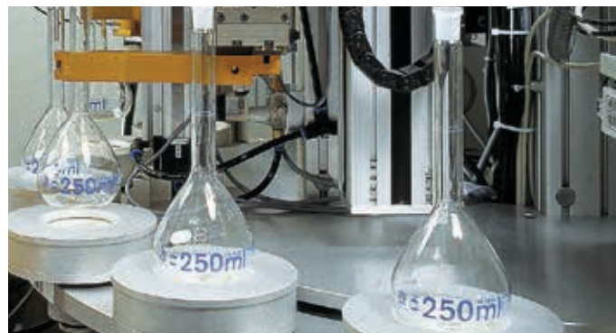
容量瓶的自动丝网印刷
