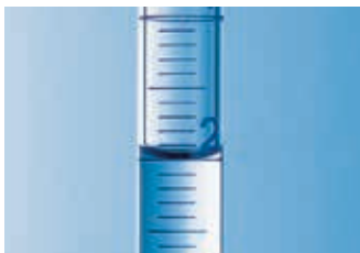
刻度移液管中的凹液面
