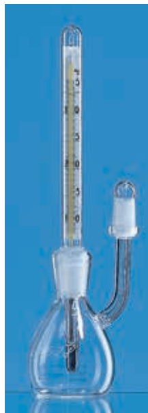
带温度计与支管的密度瓶（推荐具有高蒸汽压的液体使用）
