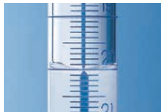
具有Schellbach标记条的滴定管中凹液面的表现。
